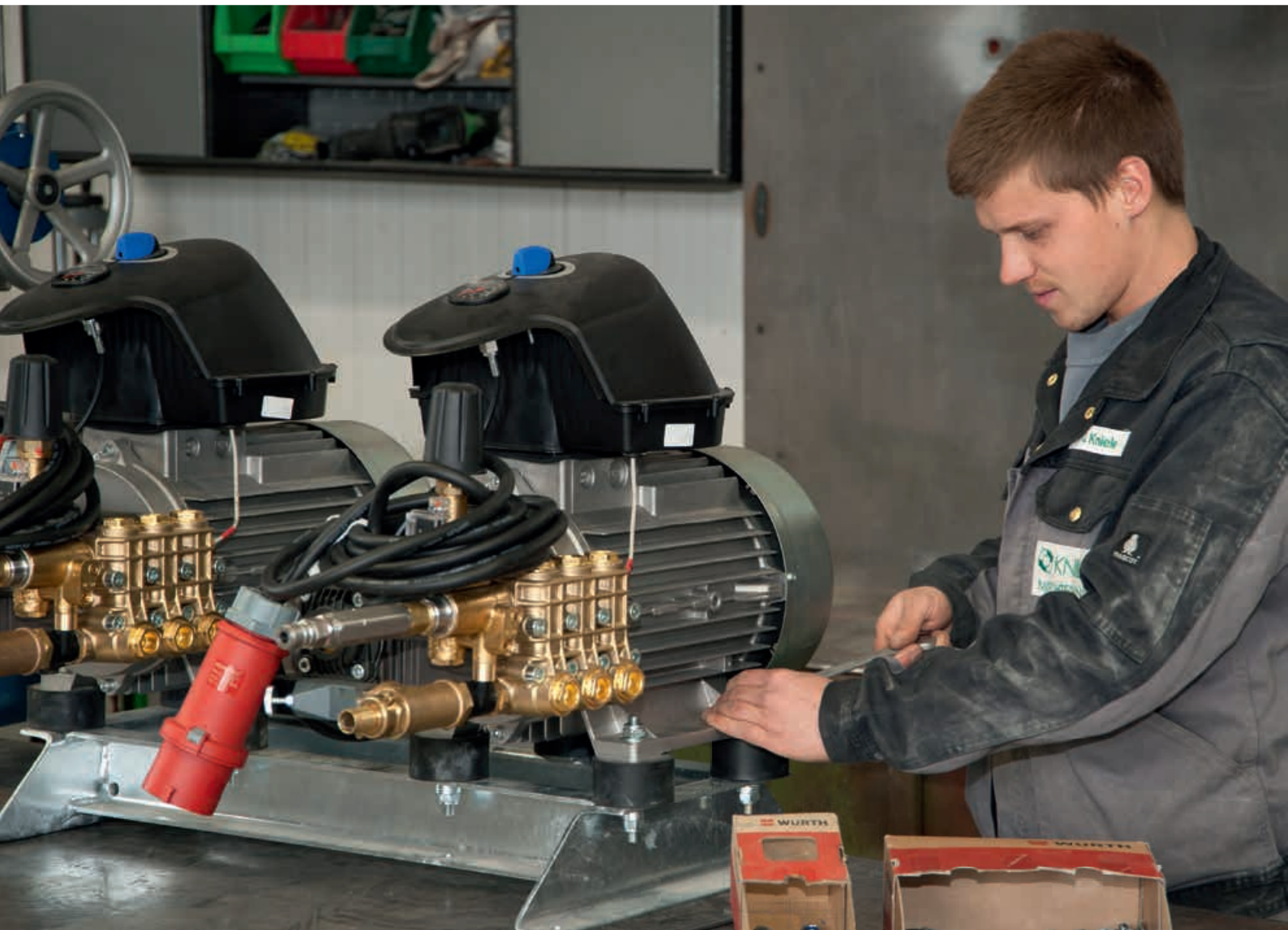
Montage der Hochdruckpumpen für die automatische Mischerreinigung
