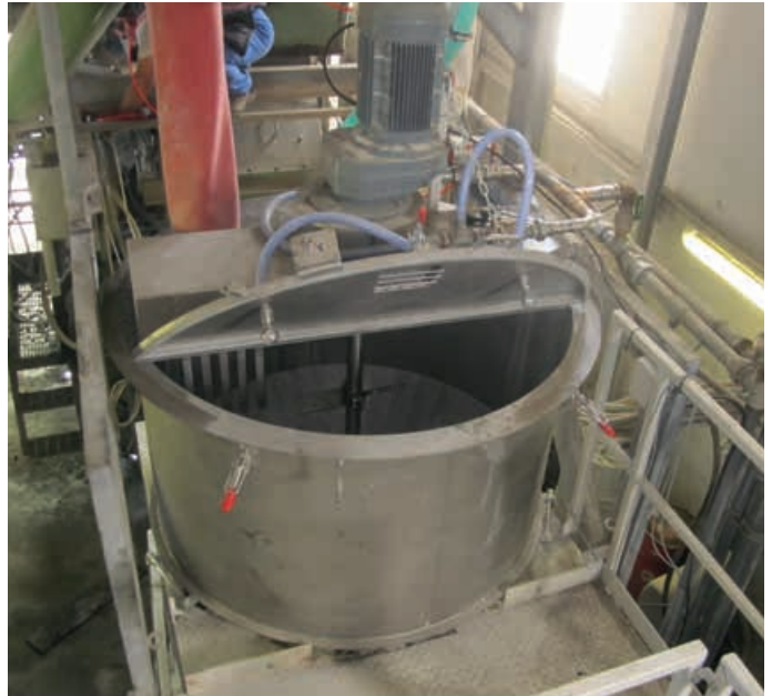
Herstellung von werksgemischtem Fließestrich
