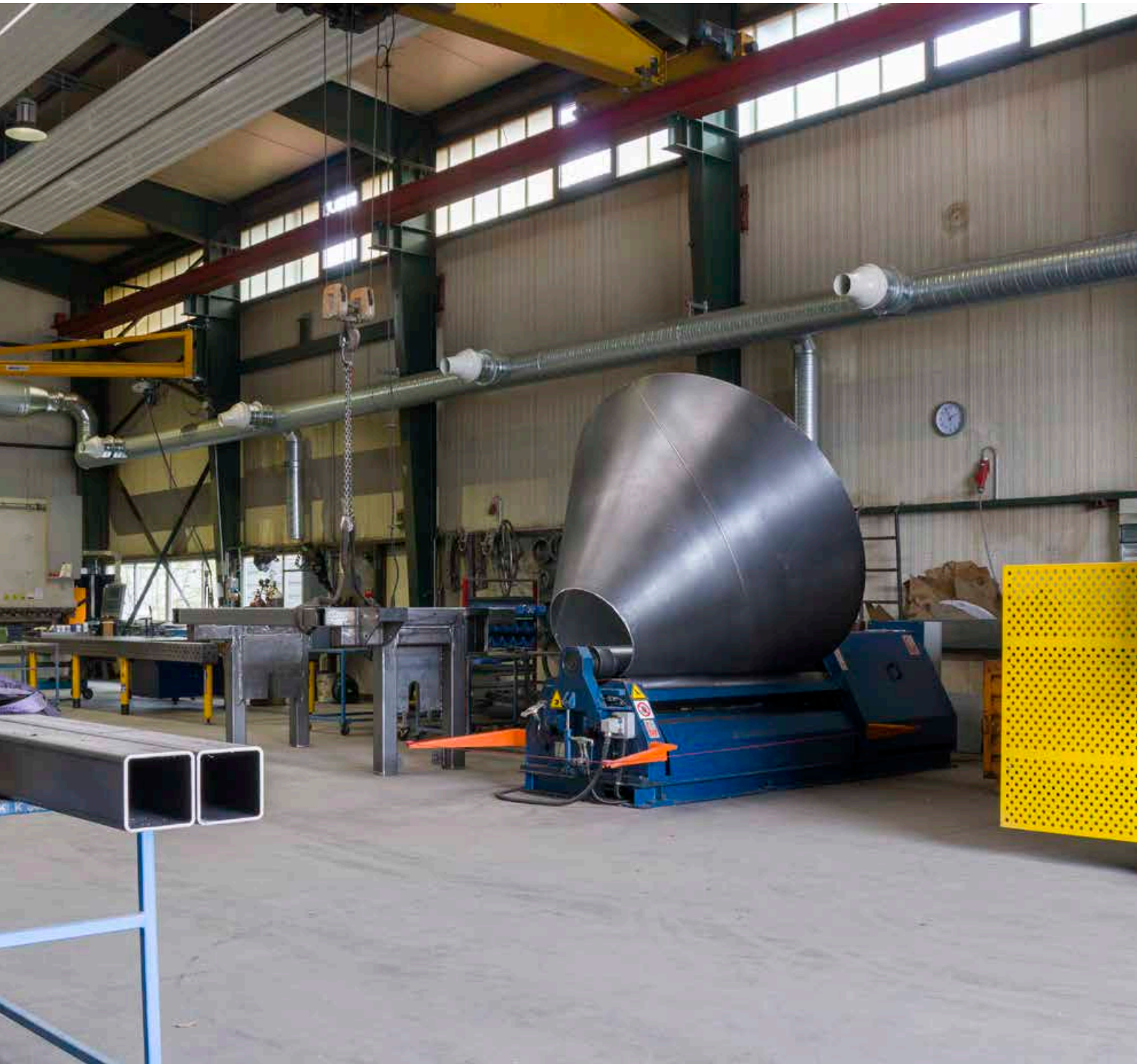
Herstellung eines Mischerkonus
