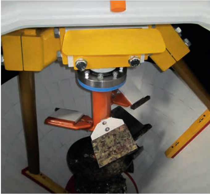
Schneckenrührwerk des Konusmischers mit Widia-Beschichtung
